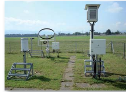
Automatic Meteorological Station in Klagenfurt-Airport (with rain gauge, radiometers and instrument shelter for thermometer and hygrometer) Automatische Wetterstation Klagenfurt-Flughafen (mit Ombrograph, Strahlungsmessgeräte und Wetterhütte für Thermometer und Hygrometer)
